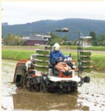
直進キープ田植機にて移植作業(令和3年5月撮影)。
