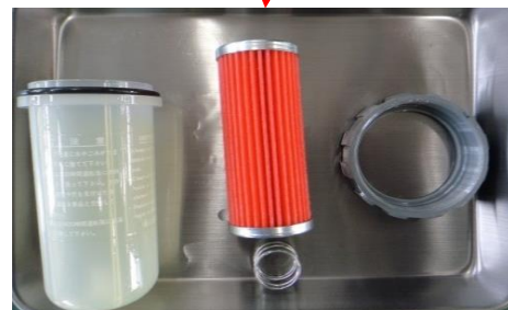
燃料フィルターを分解した様子
