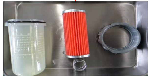
＜燃料フィルタを分解した様子＞
