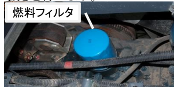
＜目視で確認できない フィルタの例＞
